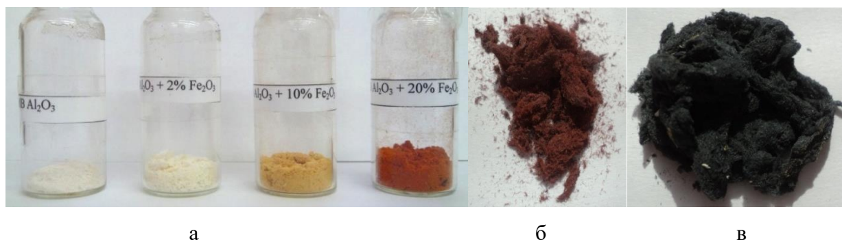
Рисунок 2.7 – Макрофотографии керамических волокон смешанных оксидов алюминия и железа (а) и \text{Fe}_2\text{O}_3 (б, в), обработанных при 700 °C (б) и 1200 °C (а, в)
