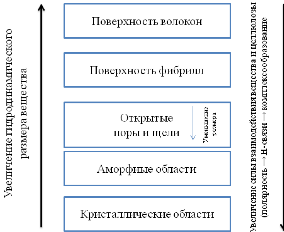
Рисунок 1.15 – Схема доступности структурных элементов целлюлозы [140]
