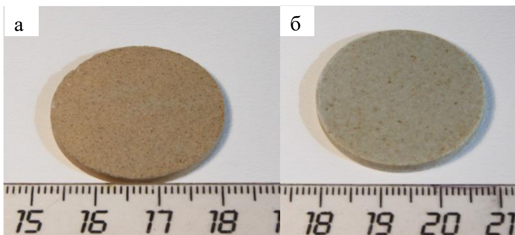
Рисунок 5.1 – Макрофотографии керамических образцов: а – состав К1 (на основе каолинита); б – состав К2 (на основе маложелезистых бокситов)
