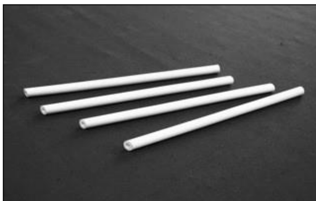
Рисунок 1.27 – Фотографии нанофильтрационных керамических мембран асимметричного типа
