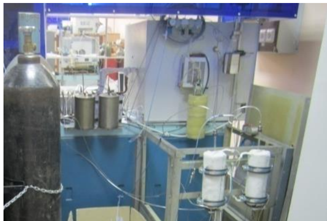
Рисунок 5.65 – Фотография установки газового реактора проточного типа
