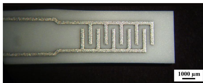
Рисунок 32. Внешний вид поверхности специализированных Pt/ \text{Al}_2\text{O}_3 /Pt сенсорных датчиков, применяемых для изучения электрофизических характеристик тонкопленочных электролитов.
