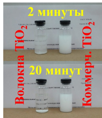
Рисунок 20 – Оценка седиментационной устойчивости диоксида титана, полученного темплатным методом (слева), и образца сравнения (справа).
