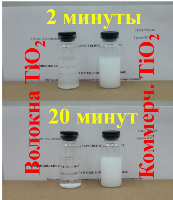
Рисунок 5.12 – Оценка седиментационной устойчивости диоксида титана, полученного темплатным методом (слева), и образца сравнения (справа).
