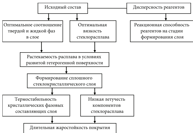
Рис. 7. Логика выбора состава композиции для получения термостабильных защитных покрытий
