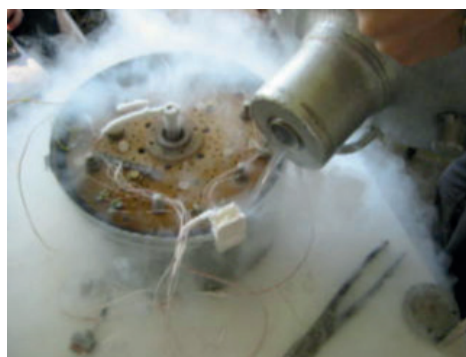
Рис. 3. Процесс захлаживания модельной синхронной машины с ВТСП-массивами на роторе жидким азотом в открытом криостате
