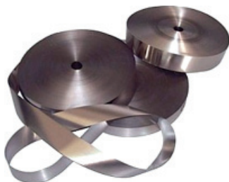
Рис. 13. Ленточные аморфные сплавы, используемые для намотки магнитных сердечников
