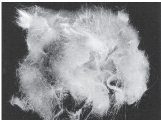
Рис. 1. Поверхностные волокна магнезиофторрихтеррита, синтезированного твердофазным методом
