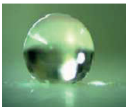
Рис. 7. Капля воды на поверхности супергидрофобного покрытия (угол смачивания равен 163^\circ ), полученного из золь-гель композиции с использованием гидрофобизированного аэросила и добавки фторалкоксисилана
