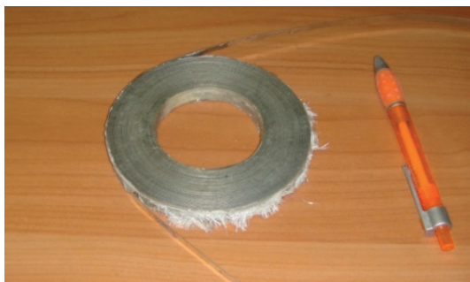
Рис. 5. Двухслойная катушка из ВТСП-ленты 1-го поколения
