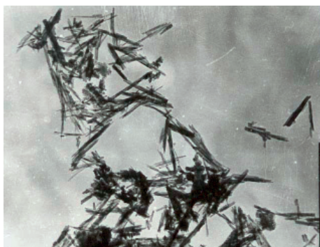
Рис. 1. Микрофотография наночастиц \text{LaPO}_4 \cdot n\text{H}_2\text{O} (просвечивающая электронная микроскопия)
