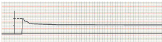
Рис. 2. Осциллограмма импульсного намагничивания объемного ВТСП
