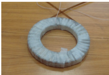
Рис. 6. Двухслойная катушка из ВТСП-ленты 2-го поколения
