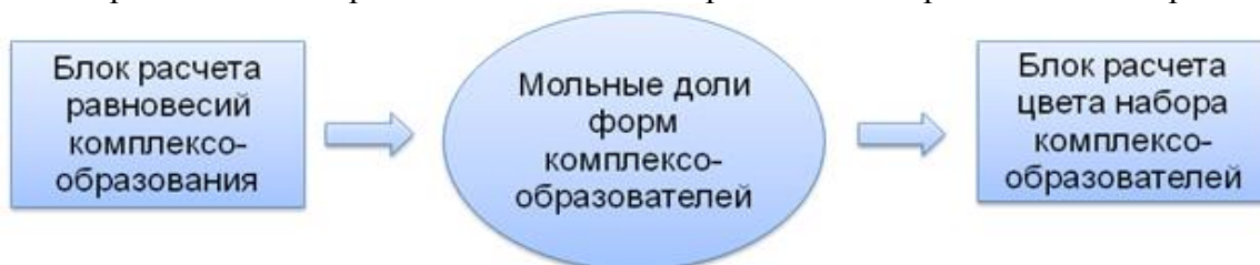
Рис. 3. Блок-схема создаваемого программного комплекса расчета цвета набора комплексообразователей от концентрации ионов.
