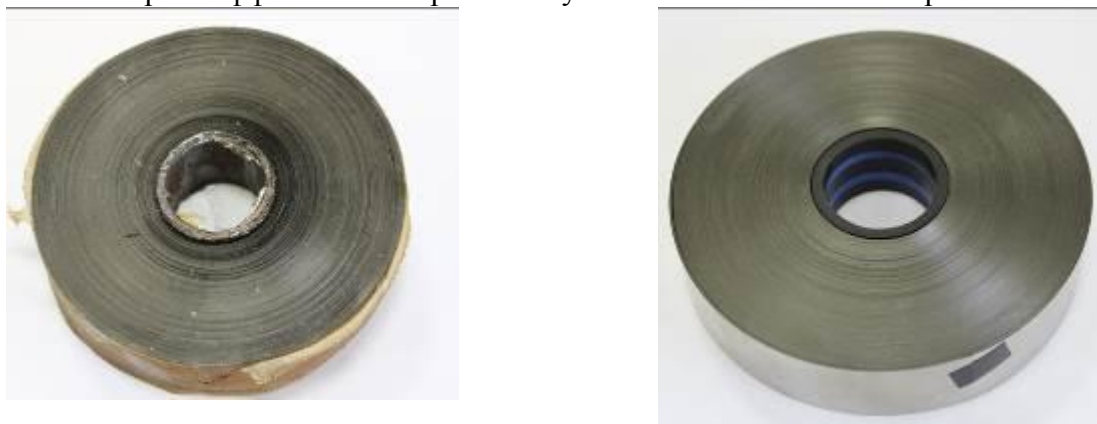
Рис. 2. Отожженный и не отожженный сердечник.
