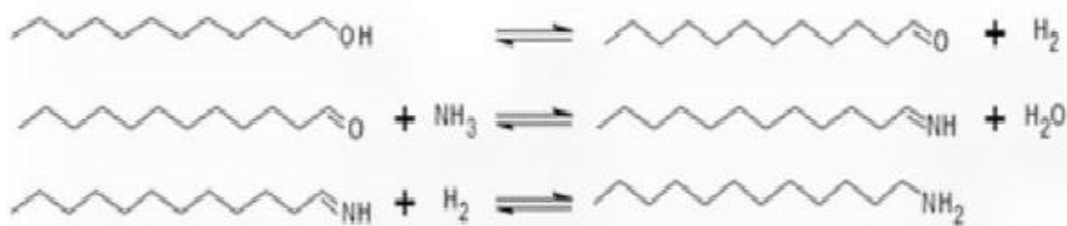
Рисунок 1 – Схема восстановительного аминирования на примере лаурилового спирта [1]
