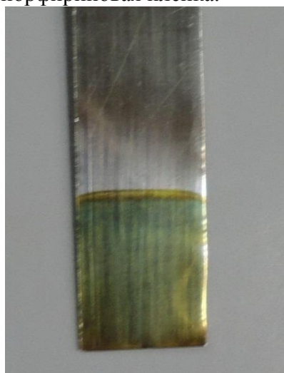
Рис. 2 Платиновый электрод, покрытый пленкой поли-Zn(II)5,10,15,20-тетракис (3'-гидроксифенил)порфина.
