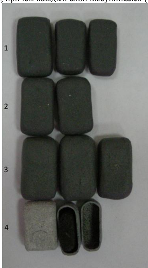
Рис. 1. Графит с покрyтиями после 1200-1300 °С 50 мин. Покрyтие с КМЦ и с разным содержанием диоксида циркония.
